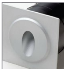
EMEX0103 EX0126REW EMBUTIDO 75x75 mm LED 2.4W 72LM 3000K IP65 AL Ø 67mm
